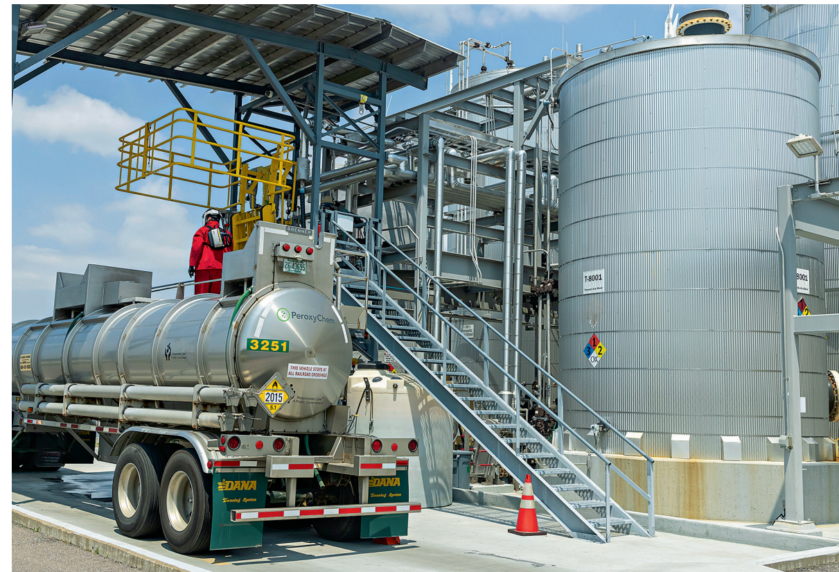
Ein Mitarbeiter bereitet das Entladen von Wasserstoffperoxid für die Herstellung des Desinfektionsmittels Peressigsäure in der Evonik-Anlage am Wolf River vor.
