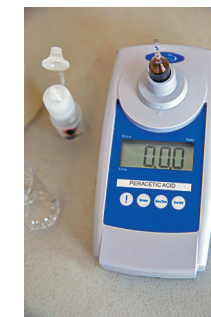
Dieses Messgerät dient zur Bestimmung der Restmenge von Peressigsäure im Abwasser.
