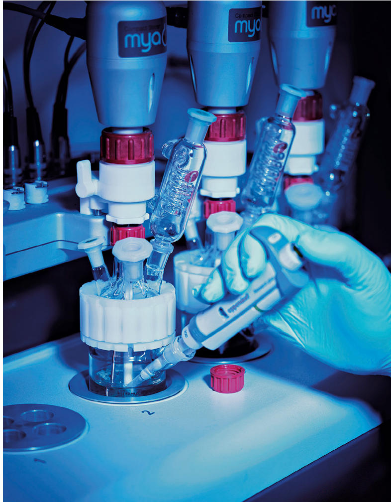
Im Hanauer Syntheselabor wird getestet, unter welchen Bedingungen das rPEG an ein Lipid gekoppelt werden kann.
