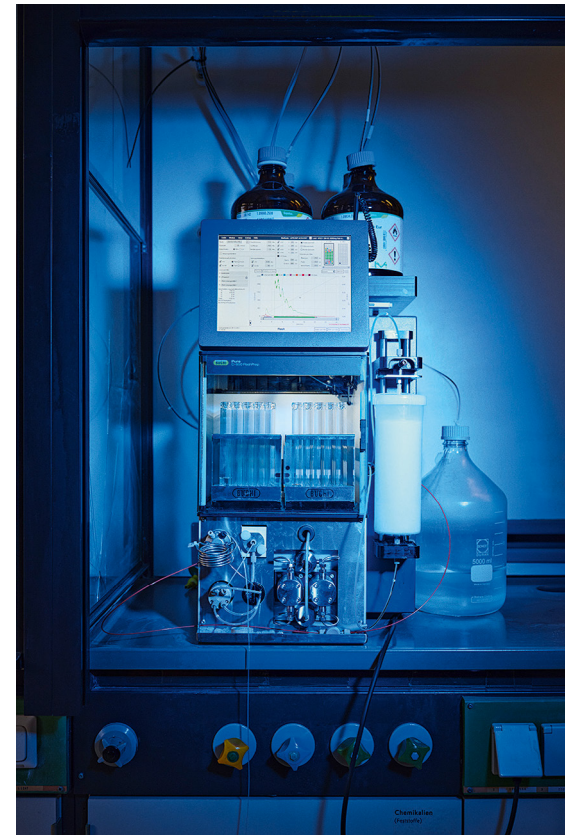
Mittels Chromatografie wird das rPEG-Lipid aufgereinigt.
