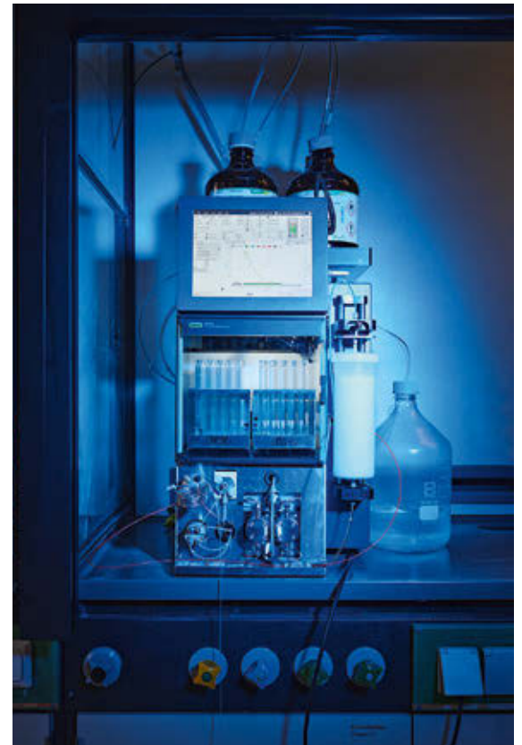
Mittels Chromatografie wird das rPEG-Lipid aufgereinigt.
