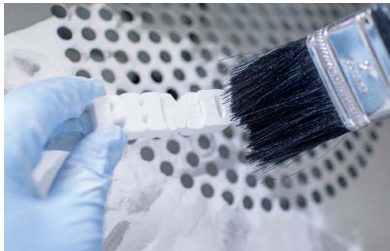
Erste Erfolge beim 3D-Druck: Dem Projekthaus ist es gelungen, Formteile aus RESOMER®-Pulver durch selektives Lasersintern herzustellen.
