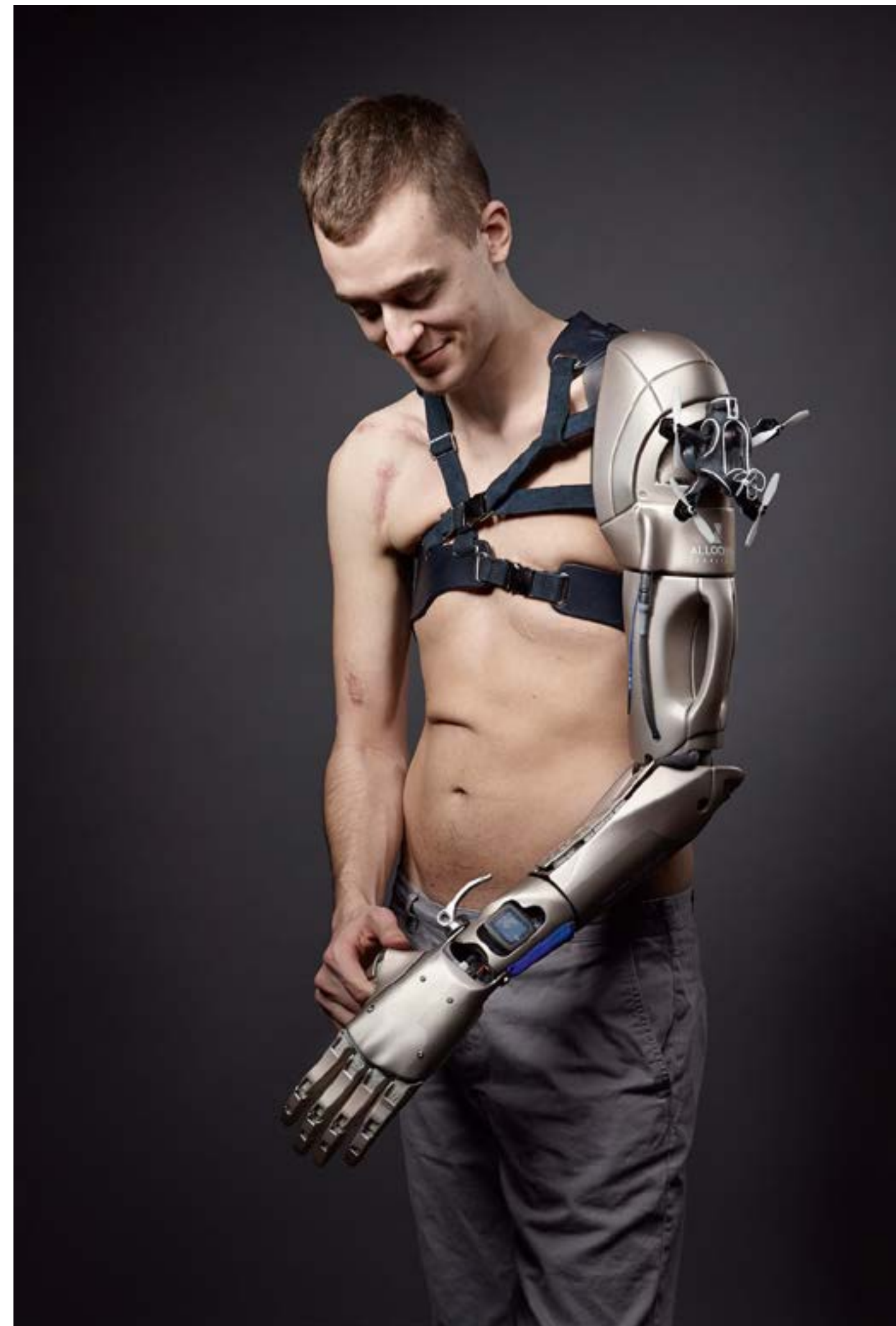
Vom Computerspiel „Metal Gear Solid“ ist die Armprothese von James Young inspiriert. Der Brite hatte bei einem Unfall einen Arm und ein Bein verloren. Die Prothese besteht zum Großteil aus Carbon und ist mit USB-Anschluss und Display ausgestattet, das unter anderem E-Mails und Herzfrequenz anzeigen kann. Entworfen wurde sie von der Londoner Designerin Sophie de Oliveira Barata.
